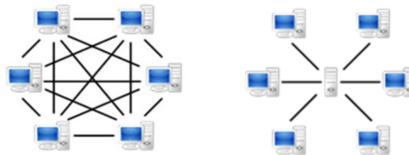
Lygiarangės ir kliento-serverio architektūros schemas
